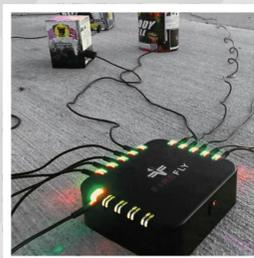
Das neue funkgesteuerte FireFly Zündmodul mit wiederverwendbaren Clips - Ein neuartiges App- und Cloud-basiertes Zündsystem, das Ihnen die Möglichkeit bietet, einfach und bequem Shows auf dem Handy zu kreieren und von dort aus zu steuern.
